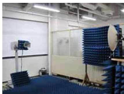
図 2 簡易アンテナ放射パターン測定装置
