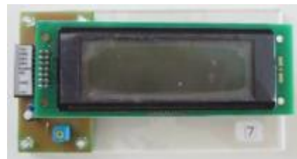
3E 実習 液晶表示器を用いた PIC プログラミング
