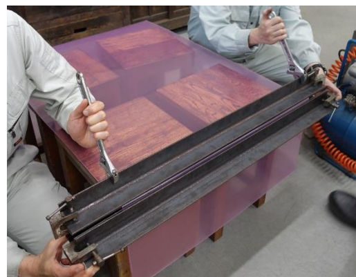
アングル材で板材を挟み、ヒートガンで加熱して曲げ加工を行った
