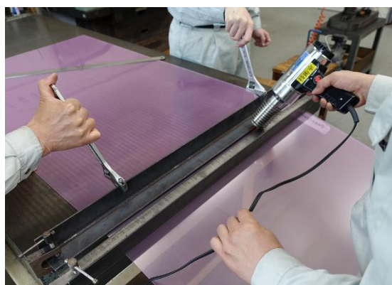
アングル材で板材を挟み、ヒートガンで加熱して曲げ加工を行った
